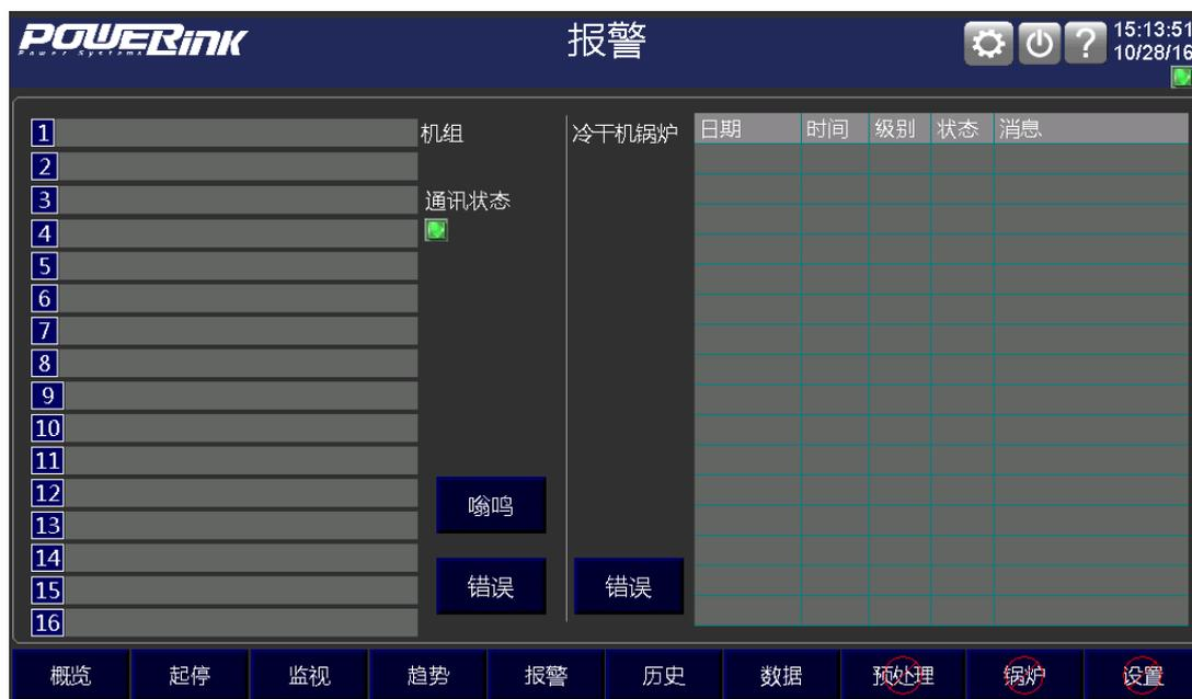
显示机组和锅炉的 16 条报警信息，可报警复位操作。点击“错误”和“嗡鸣”按钮可消除对应设备的已恢复报警信息。机组显示为 16 条当前报警信息；右侧锅炉显示 16 条历史报警和当前报警信息，包括当前发生、消除状态的信息。
