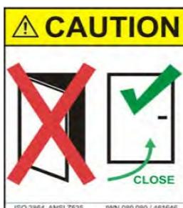
只有电气柜门关闭后，才符合电气设备正常运转的条件。（例如天气影响、热、冷、灰尘、电气柜内的空调...）。
