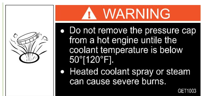
当达到运行温度时，发动机冷却水温度很高，并且存在压力，在冷却水没有充分冷却情况下，打开冷却水压力保护套，高温冷却水可能会对人员造成伤害。
